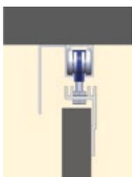
Rail aluminium fixation sous plafond
