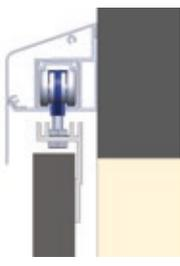
Rail aluminium fixation sur façade
